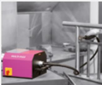
Andockbare biegsame Welle für Schleif- und Polierarbeiten an unhandlichen Werkstücken.
