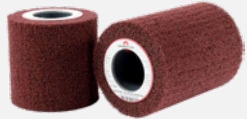
High-Tech Vlies Rad in Eco Smart Ausführung (Kosten für Innenkern, Innenhülsen oder Gießharz entfallen und Arbeitsbreiten bis 150 mm möglich). Erzeugt einen **schattenfreien Industrieschliff** (Mattieren, Satinieren). Auch zum Vorpolieren, Entfernen von Oxidschichten sowie **zum Angleichen „vorgeschliffener“ Bleche und Glätten von Oberflächen.**
