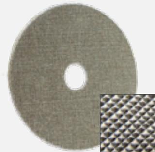
Neuartiges **Schleifgewebe** mit **pyramidenförmiger Kornstruktur** und **wärmedämmende Zusatzschicht**. **Spart** mehrere **Arbeitsgänge** dank hohem Materialabtrag mit sehr **feinem Schliffbild** und **gleichzeitigem Entfernen von Kratzern und Schweißpunkten**. Idealer Einstieg für eine spätere Spiegelglanzpolitur. Hinterlässt **geringste Rautiefen**.
