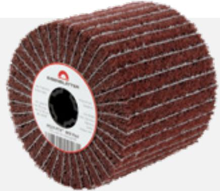
Korndurchsetztes, **hochwertiges Nylonvlies mit** vielseitigem **Edelkorund-Schleifgewebe** für gleichmäßige Nutzung über die gesamte Lebensdauer. Wirkt aggressiver als reine Vliesräder. Mit vibrationsgedämpfter Hülse für 1-fach, 2-fach und 4-fach Keilwelle, dadurch 100 % Rundlaufgenauigkeit.
