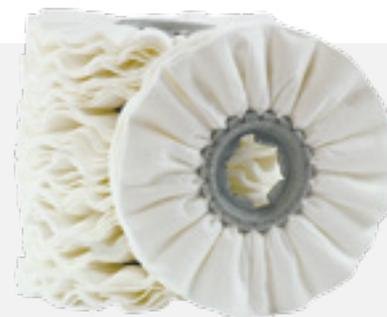
**Feine Polierringe** aus technischem Vliesstoff, **imprägniert für Edelstahl**. Für die **Hauptpolitur** von schmalen oder unebenen VA Flächen und Riffelblechen. Können dank Keilwellenloch direkt auf die POLY-PTX® 802 HT aufgeschoben werden. 8 Stück passen perfekt auf die 100 mm POLY-PTX® Welle.
