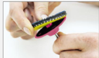
Sekundenschneller Scheibenwechsel mit dem Eisenblätter FIX KLETT und MINI FIX System. 100 % Rundlauf durch Zentrierzapfen.
