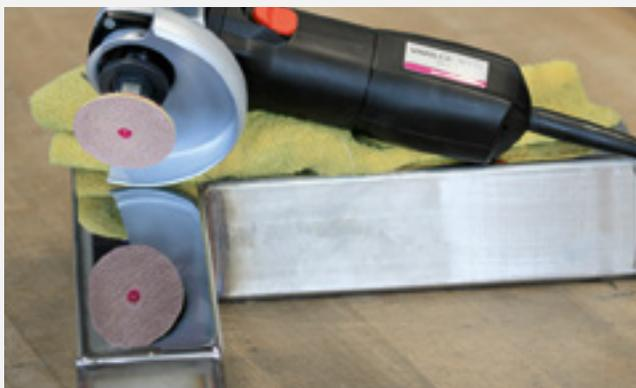
Anwendung einer MINI FIX CoolTop® Fächerschleifscheibe
