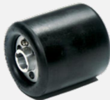
Für die **individuelle „Härte-Einstellung“** der jeweiligen Zirkon, Keramik, SC Vlies, Trizact™, SuperPolish, BRIGHTEX<sup>®</sup> und Filz **Hülsen** empfiehlt sich diese aufpumpbare Expansionswalze. Sie eignet sich besonders für den Flächen- und Kantenschliff. Kann auch mit jeder Fahrradpumpe o.ä. aufgeblasen werden (für individuelle Druckeinstellung, Adapter enthalten).
