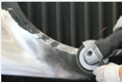
Entlackung mit gleichzeitigem Oberflächen-Finish.
