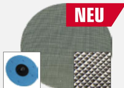
Neuartiges **Schleifgewebe** mit **pyramidenförmiger Kornstruktur** und **wärmedämmende Zusatzschicht**. **Spart** mehrere **Arbeitsgänge** dank hohem Materialabtrag mit sehr **feinem Schlibbild** und **gleichzeitigem Entfernen von Kratzern und Schweißpunkten**. Idealer Einstieg für eine spätere Spiegelglanzpolitur. Hinterlässt **geringste Rautiefen**.
